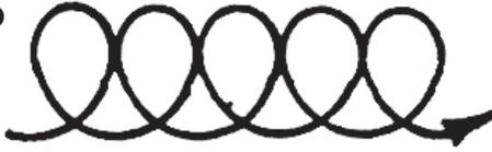
La barretta di apporto deve muoversi in sincronia con la torcia e deve immergersi con un rapido movimento di va e vieni nel bagno di saldatura.
