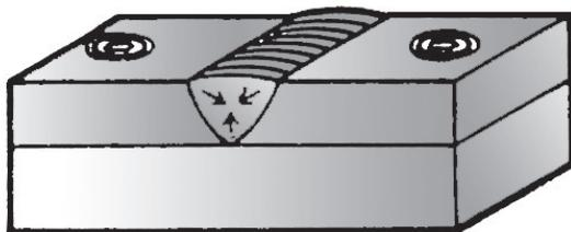
**Durante il raffreddamento:** se la forza delle tensioni provocate dalla saldatura è superiore alla resistenza del cordone o della zona adiacente, il giunto si spacca
