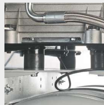
Base motore / unità installata su 4 supporti antivibranti in gomma per minori vibrazioni, rumorosità ridotta e maggiore durata (solo su modelli Diesel)
