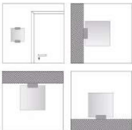
UNIVERSAL è adatto per pannelli di vari materiali e diversi spessori: è sufficiente inserire il cartello nel supporto nel modo che si desidera, fissarlo con una vite senza testa e fare una leggera pressione sulla cover.
